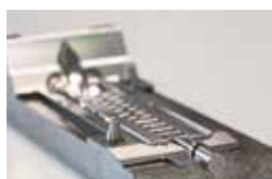
Outillage d'injection de silicone conçu par Cisteo Medical
