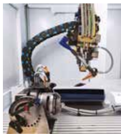
Soudure de boîtier implantable réalisée en salle blanche
